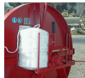
Durch spezielle Verknotung dauerhafter Halt der Schnur, 400m = ca. 50 Bündel
