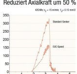
Argument Nr. 1 Reduziert Axialkraft um 50 %
