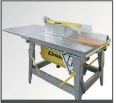
Für größere Werkstücke ist der gleitlagergeführte Quer- & Längsanschlag, wie auch die Tischverlängerung, aufund abklappbar.
