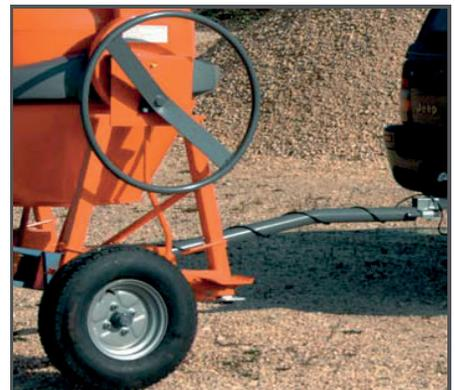
Großes Handrad mit Schwenkgetriebe
