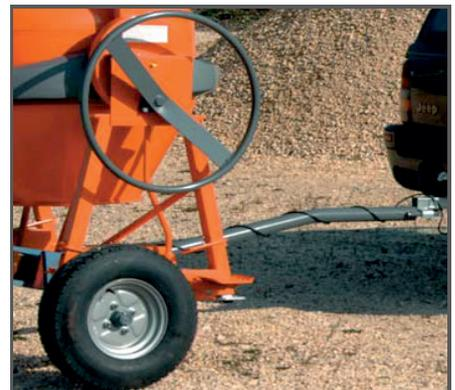
Großes Handrad mit Schwenkgetriebe
