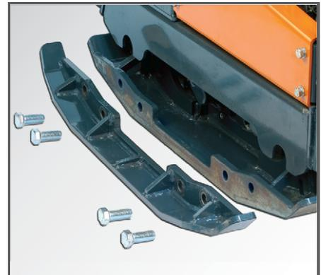
Inklusive 2x 75 mm Verbreiterungen für die Grundplatte. Die Grundplattenbreite wird dadurch von 450 mm auf 600 mm vergrößert.
