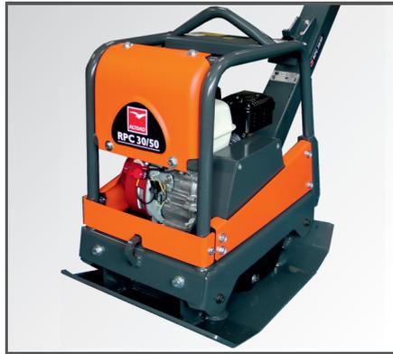
Der robuste Rahmen schützt die Rüttelplatte im harten Arbeitsalltag. Abnehmbare Abdeckungen, Riemenspanner und ein selbstansaugendes Hydrauliksystem ermöglichen eine einfache Wartung.
