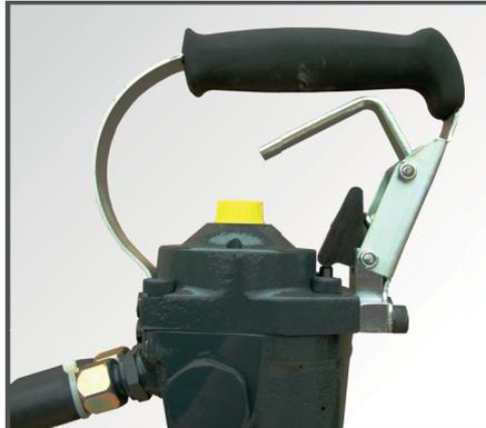
Vibrationsdämpfender „D-Griff“ des BHB 12 für den horizontalen Einsatz.
