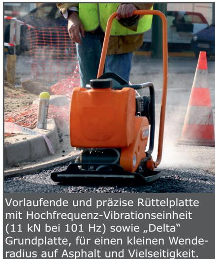
Vorlaufende und präzise Rüttelplatte mit Hochfrequenz-Vibrationseinheit (11 kN bei 101 Hz) sowie „Delta“ Grundplatte, für einen kleinen Wenderadius auf Asphalt und Vielseitigkeit.
