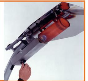
Zum Wechseln der Gasflasche wird die große Gehäuseabdeckung leichtgängig nach hinten geklappt. Hier befinden sich auch die Sicherheitselemente, der Kippschutzschalter, die Überdruck- und Schlauchbruchsicherung.
