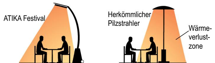
Der Edelstahl-Reflektor kann durch das Drehen der Einstellschraube leicht und exakt auf die Personengruppe, bzw. die zu heizende Fläche ausgerichtet werden.
