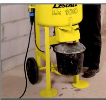
Die klappbare Eimerkonsole ermöglicht ein direktes Entleeren des Mischgutes z.B. in einen Mörteleimer oder in eine Schubkarre.
