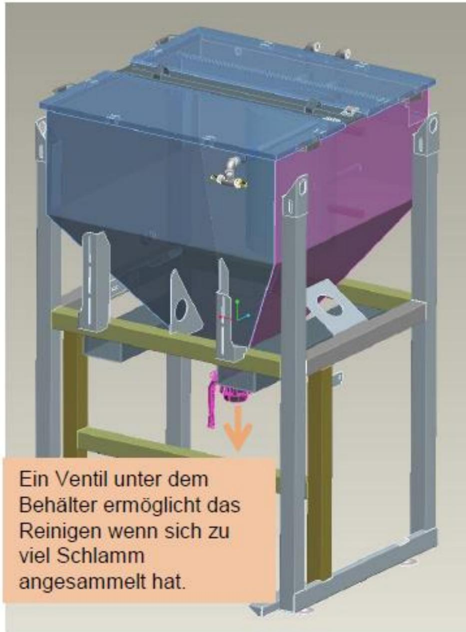
Ein Ventil unter dem Behälter ermöglicht das Reinigen wenn sich zu viel Schlamm angesammelt hat.
