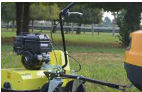
Hebegriff mit automatischer Betätigung des Schneidsystems
