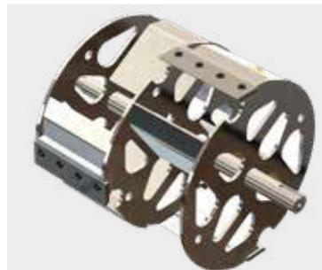
**Trommel-Schnittsystem** mit 4 Messern. Radial gibt es „Schaukeln“, die sich mit hoher Geschwindigkeit drehen und einen Luftstrom erzeugen, der erforderlich ist, um das bearbeitete Material - auch wenn es sehr feucht ist - in einer Höhe von ungefähr 2 m auszuwerfen..
