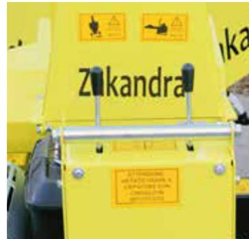
**Steuerungen:** 2 Hebel an der „Steuerkonsole“ ermöglichen die separate Steuerung der rechten und linken Raupe.
