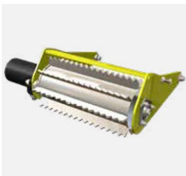
Leichtes Einföhren des Schnittguts durch hydraulischen: es handelt sich um eine Zahnwalze aus Stahl mit einem Durchmesser von 190mm am Ende des Ladetrichters und unmittelbar vor dem Schneidsystem. Um das zu häckselnde Material in das Schneidsystem zu ziehen (Breite 332 mm).
