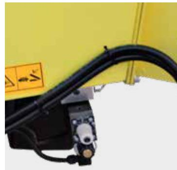
**Regulierung der Geschwindigkeit der Einzugswalze.** Die Geschwindigkeit der Einzugswalze wird über den Reglerknopf (hydraulischer Mengenteiler) eingestellt.
