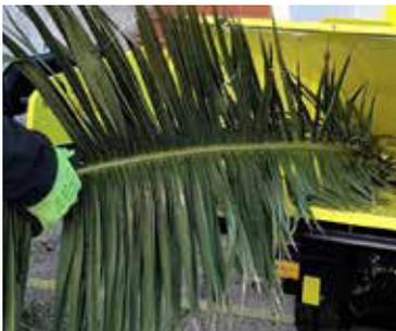
Schnitt bis zu 15 cm jeder Art von Holz- oder Faserabfall (einschließlich Palmenschnitt).
