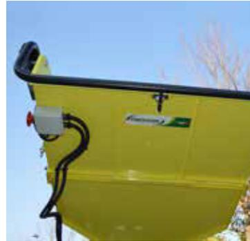
Nur für Modelle mit Trichter „TL1“, **regulierung der Geschwindigkeit** und Umkehrung der Einzugswalzen über elektrische Antriebe und Steuerungen.
