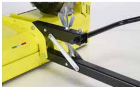
**System zur Einstellung der Arbeitshöhe.** Sitzt man auf dem Traktor/Quad, kann man durch Bedienen des Hebels die Maschine anheben, um zu vermeiden, dass die Messer den Boden berühren.
