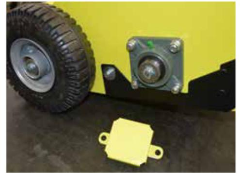
Das **Schneidsystem** wird von zwei Gusseisenstützen und zwei hochwertigen Kugellagern getragen. Die Schmiervorrichtung ist bei Wartungsarbeiten leicht zu erreichen.
