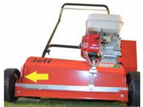
**BEWEGLICHE RADHALTERUNGSACHSE** Das Schnittsystem bleibt immer parallel zum Erdboden (auch bei Unebenheiten)
