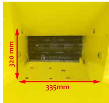
**Unterer Trichter:** Ein weiterer Vorteil, der den Häcksler Zakandra auszeichnet ist die Breite der Ladeöffnung, die auch an der Schneidstelle breit bleibt. Dadurch ist die Maschine in der Lage, besonders belaubtes Material zu häckseln, wie zum Beispiel der Beschnitt von Olivenbäumen, ohne dass Verstopfungen auftreten und bei jeder Ladung das Häckseln großer Mengen an Material ermöglicht mit einer beträchtlichen Reduzierung der Arbeitszeiten.
