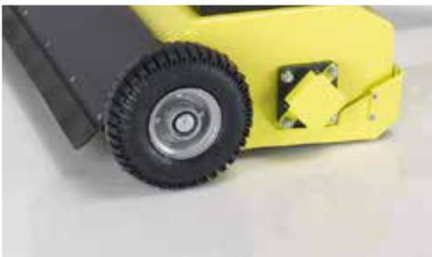
**Weiche Gummiräder**, die das Gras nicht beschädigen, und halbvolle Räder, die weder Luft verlieren noch durchlöchert werden können. Mit Kugellagern und auf einer Achse mit 20 mm Durchmesser montiert.
