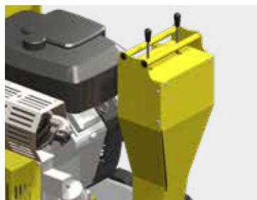
**Steuerungen:** 2 Hebel an der „Steuerkonsole“ ermöglichen die separate Steuerung der rechten und linken Raupe.
