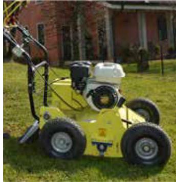
**Räder:** 4 pneumatische Räder Durchmesser 280 mm, Breite 100 mm
