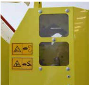
Dank des transparenten Fensters kann in die Schneidkammer gesehen werden, ohne diese zu öffnen.
