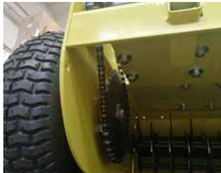
**Differenzialsystem** durch Ritzel mit Freilauftrieb und Kettenantrieb
