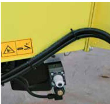
Nur für Modelle mit Trichter „TL1“, **Regulierung der Geschwindigkeit der Einzugswalze.** Die Geschwindigkeit der Einzugswalze wird über den Reglerknopf (hydraulischer Mengenteiler) eingestellt.
