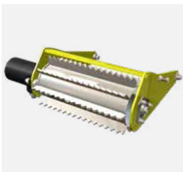
Leichtes Einführen des Schnittguts **durch hydraulischen:** es handelt sich um eine Zahnwalze aus Stahl mit einem Durchmesser von 190mm am Ende des Ladetrichters und unmittelbar vor dem Schneidsystem. Um das zu häckselnde Material in das Schneidsystem zu ziehen (Breite 332 mm).
