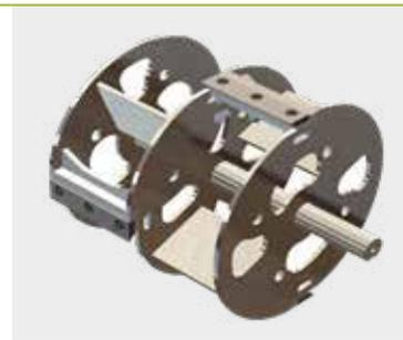
**Trommel-Schnittsystem** mit 4 Messern. Radial gibt es „Schaufeln“, die sich mit hoher Geschwindigkeit drehen und einen Luftstrom erzeugen, der erforderlich ist, um das bearbeitete Material - auch wenn es sehr feucht ist - in einer Höhe von ungefähr 2 m auszuwerfen..
