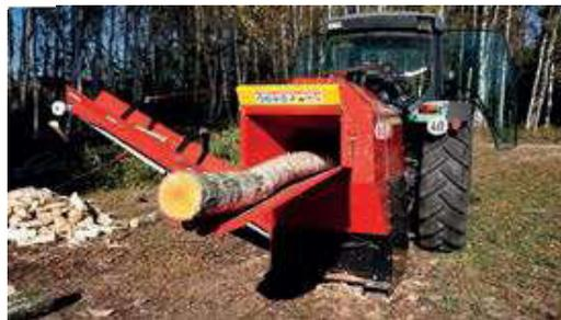
■ Der Holzhacker und -spalter RP-300 ist ein effizientes Gerät zum Schneiden und Spalten des Holzmaterials von bis zu 20 cm Stärke.
