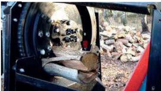
Die Scheibe zum Schneiden und Spalten – die Schnittlänge kann mit den hydraulisch gesteuerten Einzugsrollen eingestellt werden.
