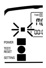
Wenn das rote Licht blinkt, müssen die Batterien innerhalb von 15 Sekunden ausgewechselt werden, um sicherzustellen, dass die aktuellen Einstellungen beibehalten werden. Danach stellt sich der Spender auf die Standardeinstellung eines Sprühbetriebs von 24/7 zurück.
