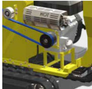
Die Fliehkraftkupplung ermöglicht den Start des Motors, ohne das Schneidschwungrad zu belasten.
