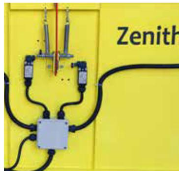
Regulierung der Geschwindigkeit und Umkehrung der Einzugswalzen über elektrische Antriebe und Steuerungen.
