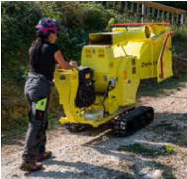
Die Bewegungen werden bei eingeklapptem Trichter und abgesenktem Auslauf erleichtert.
