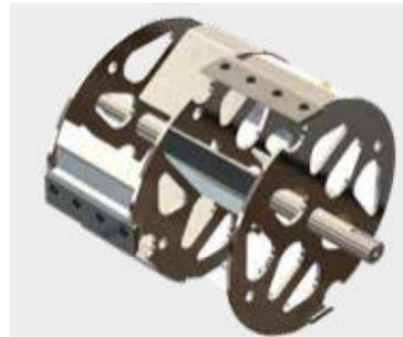
**Trommel-Schnittsystem** mit 4 Messern. Radial gibt es „Schaufeln“, die sich mit hoher Geschwindigkeit drehen und einen Luftstrom erzeugen, der erforderlich ist, um das bearbeitete Material - auch wenn es sehr feucht ist - in einer Höhe von ungefähr 2 m auszuwerfen..
