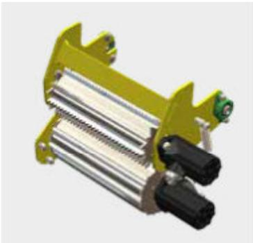
Die beiden von zwei Hydraulikmotoren angetriebenen Zahnwalzen sorgen für den Einzug von schweren und belaubten Stämmen in die Schnittkammer. Die Geschwindigkeit kann über einen Knopf an der Maschine reguliert werden.
