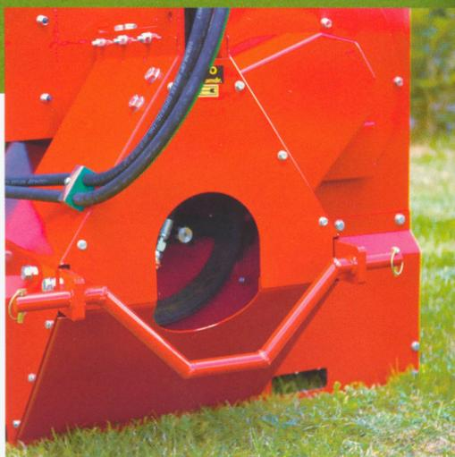
Der **LOMA K30 H** wurde speziell für die Montage an kleineren Traktoren entwickelt und zeichnet sich durch ein geringes Eigengewicht und einen niedrigen Energiebedarf aus. Aufgesattelt für Zapfwellenbetrieb.
